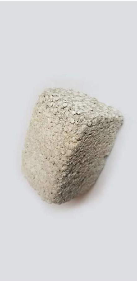
Zdj. 12. Kostka wykonana ze styrobetonu.
