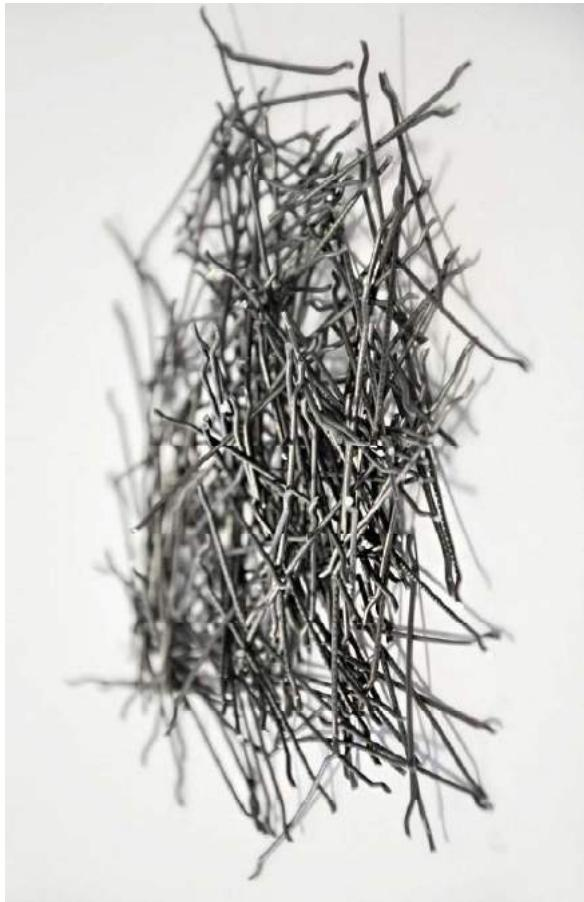
Zdj. 37. Przykład zbrojenia rozproszonego stalowego.
